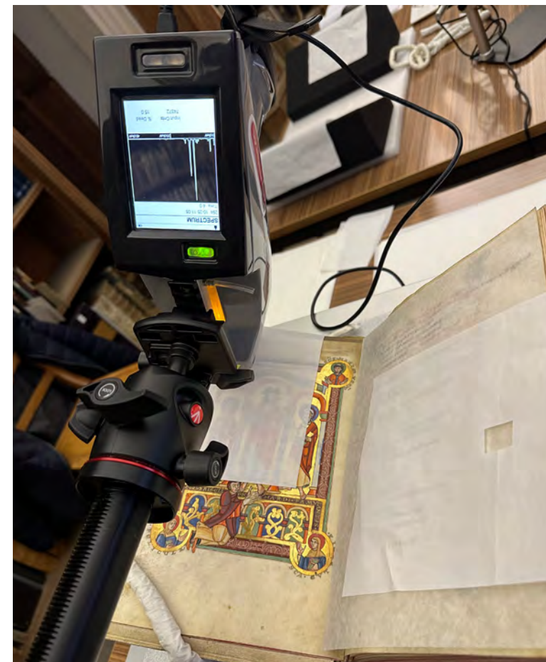
Zerstörungsfreie Analysen mittels Handheld XRF im Rahmen des Forschungsprojekts zu den heiligen Schriften in der Staatsbibliothek Bamberg.
